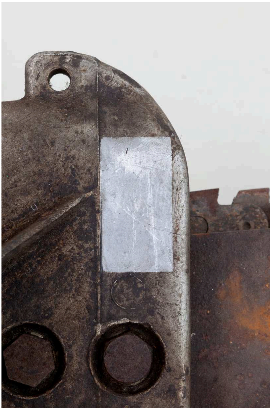
S01 - zkouška snímání tukových a prachových depositů - uložení řetězu
