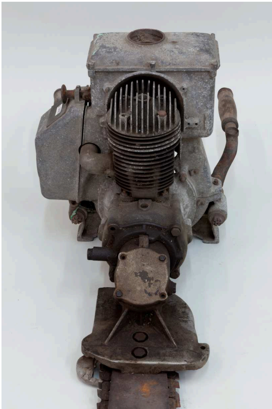
Stav před restaurováním - Motorová pila - motorová část
